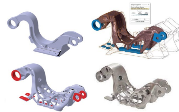
Şekil 2. Krüger kanat braket için yapılmış DfAM çalışması, ASCO ve SLM Solutions®.
