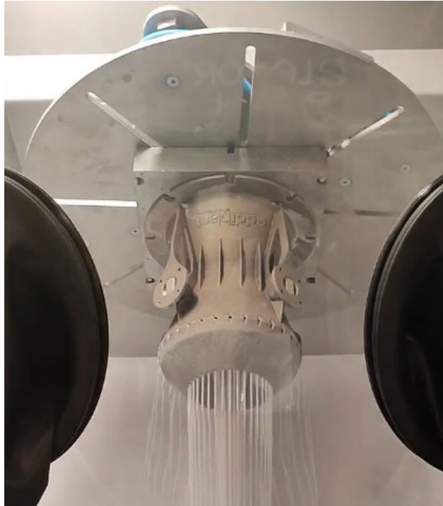
Şekil 4. Addiblast sistemlerinde toz temizleme işlemi.
