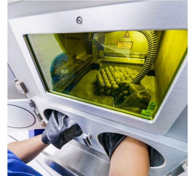
Şekil 3. Makine kapağı açılmadan toz temizleme işlemi, SLM®280 2.0 PSV.
