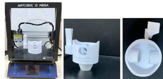
Şekil 14. a) 3D eklemeli yazıcıda pistonun üretim aşaması, b) üretimi tamamlanmış yolluklu, besleyicili piston modeli.
